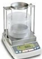
PBS-A04 Set zur Dichtebestimmung von Flüssigkeiten und Feststoffen
