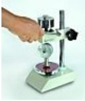
Prüfstand TI-AC Sauter, Geeignet für HBA,HB0
