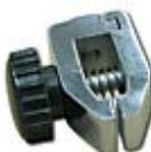
AC 14 Kleinklammer-Aufsatz für Zug- und ReissTests bis 500 N (2 Stück)
