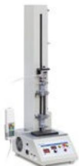
Prüfstand TVO 2000N500S Sauter, Messbereich 2000N
