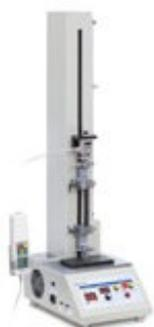
Prüfstand TVO 500N500S Sauter, Messbereich 500N
