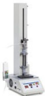
Prüfstand TVO 1000N500S Sauter, Messbereich 1000N
