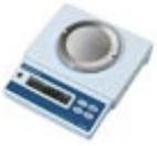
Präzisionswaage **EL 120** Wägeber. 120 g/Teilung 0.01g Plattformdurchm. 110 mm
