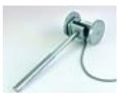
Haltegriff (Länge: 300 mm) und zwei runde Kraftaufnahmeplatten (Ø 85 mm)
