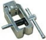
AC 01 Spitzklammer-Aufsatz für Zug- und Reiss tests bis 500 N (2 Stück)
