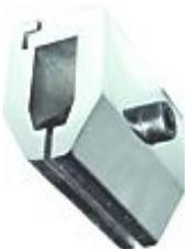
AC 03 Flachbacken-Aufsatz für Zugtests bis 5 kN (2 Stück)
