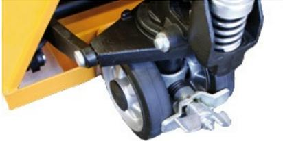
Bremse zu Palettenhubwagen- Waage
