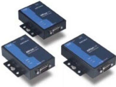
Wandelt die Datenschnittstelle der Waage von RS232 auf Ethernet 10/100 Mbps, RJ45 um.
