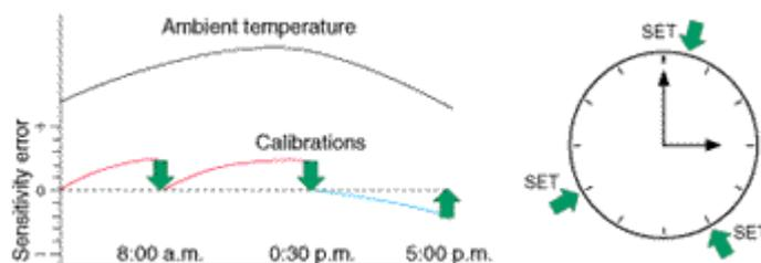
Unabhängig von der PSC-Funktion können ferner daher bis zu 3 Uhrzeiten täglich festgesetzt werden, an denen sich die Waage zeitgesteuert justieren soll. Zum Beispiel, zum Arbeitsbeginn, nach der Mittagspause und zum Schichtwechsel. Lästiges überprüfen vor Beginn einer Messreihe entfällt damit.
