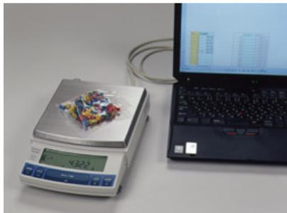
Dank der Windows® Direct-Funktion ist die Datenkommunikation zwischen der Waage und einem PC denkbar einfach geworden. Es wird lediglich ein Nullmodem-Kabel benötigt. Die Daten werden direkt in Ihre Windows™-Applikation (Laborsoftware, Datenbank, Tabellenkalkulation, etc.) übertragen. Eine zusätzliche Software wird nicht benötigt .
