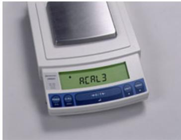
Die Modelle der UX-Serie sind für die Justierung mit externen Gewichten ausgelegt. Dennoch ist die Justierung denkbar einfach: Per Knopfdruck wird der Kalibriermodus aufgerufen. Anschließend das entsprechende Gewicht auf die Waagschale legen und den Anweisungen auf der Anzeige folgen. Fertig !
