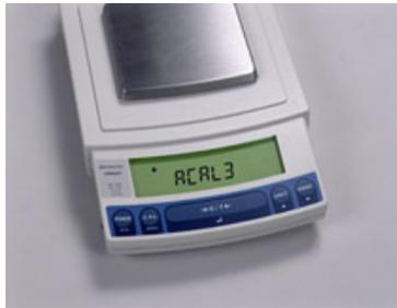
Durch die motorgetriebenen internen Justiergewichte werden Kalibrierungen der Waagen zum "Kinderspiel" : Per einfachem Knopfdruck können diese zu jedem beliebigen Zeitpunkt gestartet werden. Zusätzlich können Kalibrierungen auch vollautomatisch mittels der PSC- und/oder Clock-Cal-Funktion durchgeführt werden :
