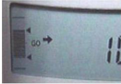
Auch Kontrollwägungen von Gegenständen immer gleicher Gewichte können einfach durchgeführt werden. Durch Setzen eines unteren und oberen Schwellenwertes zeigt die Kapazitätsanzeige an, ob sich der Messgegenstand innerhalb der erlaubten Toleranzen befindet. Die Kontrollwerte "GO", "HI" and "LO", die auch als Analogwerte an zusätzliche Instrumente angeschlossen werden können, ermöglichen eine rasche optische Entscheidungsfindung, z.Bsp. in der Qualitätskontrolle oder in der Verpackung.
