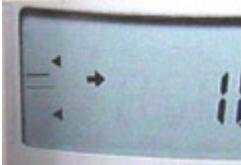
Wählen Sie ein Zielgewicht und die erlaubte Toleranz. Die Kapazitätsanzeige signalisiert Ihnen, wann das Zielgewicht erreicht wird. Dies ist z.Bsp. beim Wiegen teurer Produkte hilfreich.
