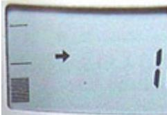
Die analoge Kapazitätsanzeige informiert über die gegenwärtige tatsächliche Last auf der Waage (incl. Tara). Dies ist besonders bei der Rezeptierung und bei der Herstellung von anderen Gemischen hilfreich.
