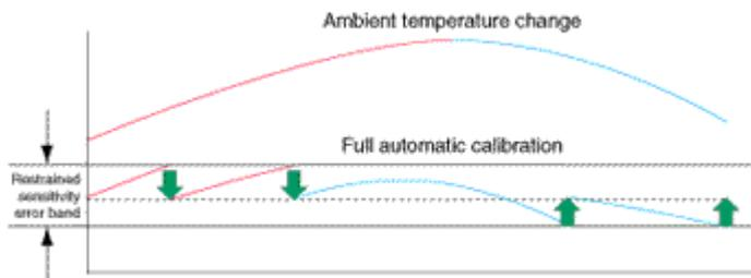
Die PSC-Funktion ermittelt jederzeit die Umgebungstemperatur der UW-Waagen. Werden die Toleranzgrenzen nach oben oder unten überschritten wird dieses signalisiert und die notwendige Justierung vollautomatisch vorgenommen. Dadurch wird sichergestellt, dass die Waage zu jedem Zeitpunkt optimal einsatzbereit ist.
