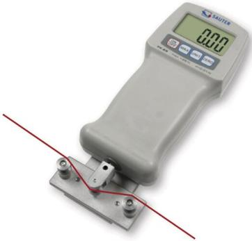
SAUTER FK-A01 optionaler Aufsatz für Zugspannungsprüfungen. Mit diesem Aufsatz wird aus dem SAUTER FK Kraftmessgerät ein Tensiometer zur Prüfung von Materialspannungseigenschaften von Kabeln, Drähten, Fäden, Schnüren etc. Materialdicke bis  $\varnothing$  5mm und Zugspannungsprüfung bis max. 250N
